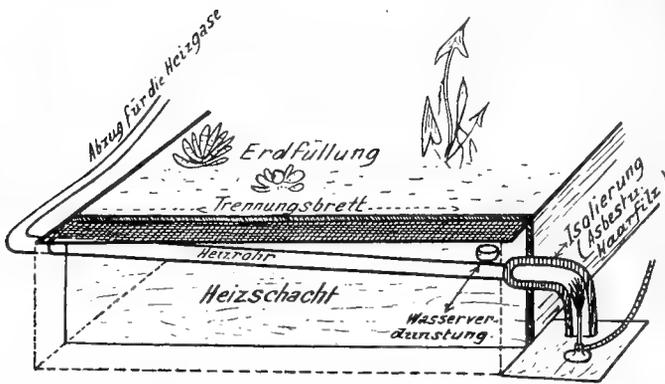
Rohr-Luftheizung für feuchtwarne Dauerterrarien
